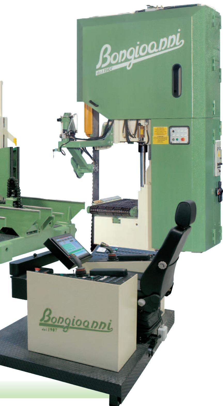
**GIRATRONCHI** a doppio snodo composto da due bracci indipendenti con sollevamento idraulico. E' dotato di tre catene motorizzate con rotazione a destra e sinistra ed inclinazione sino a 90°. Ideale per ogni tipo di tronco e per ribaltare quadrati, senza rovinare gli spigoli.
