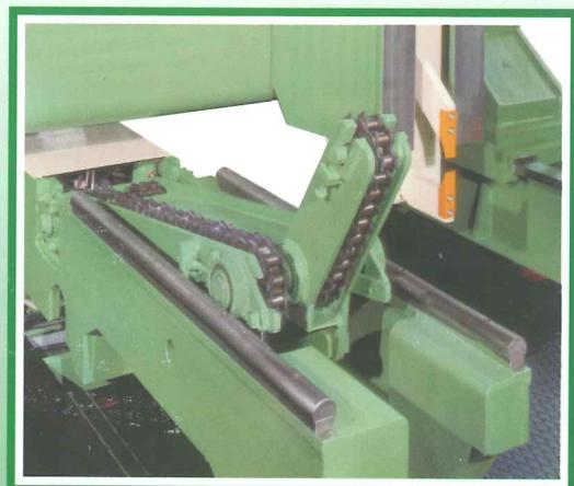
**DOPPELGELENKSTAMMWENDER** mit 2 unabhängigen Arme hydraulisch hebbar, jeder Arm ist mit einer getriebenen Kette ausgerüstet mit Drehung nach rechts und links. Geeignet für jede Stammart sowie für Kantholzkippen ohne die Kante zu beschädigen.
