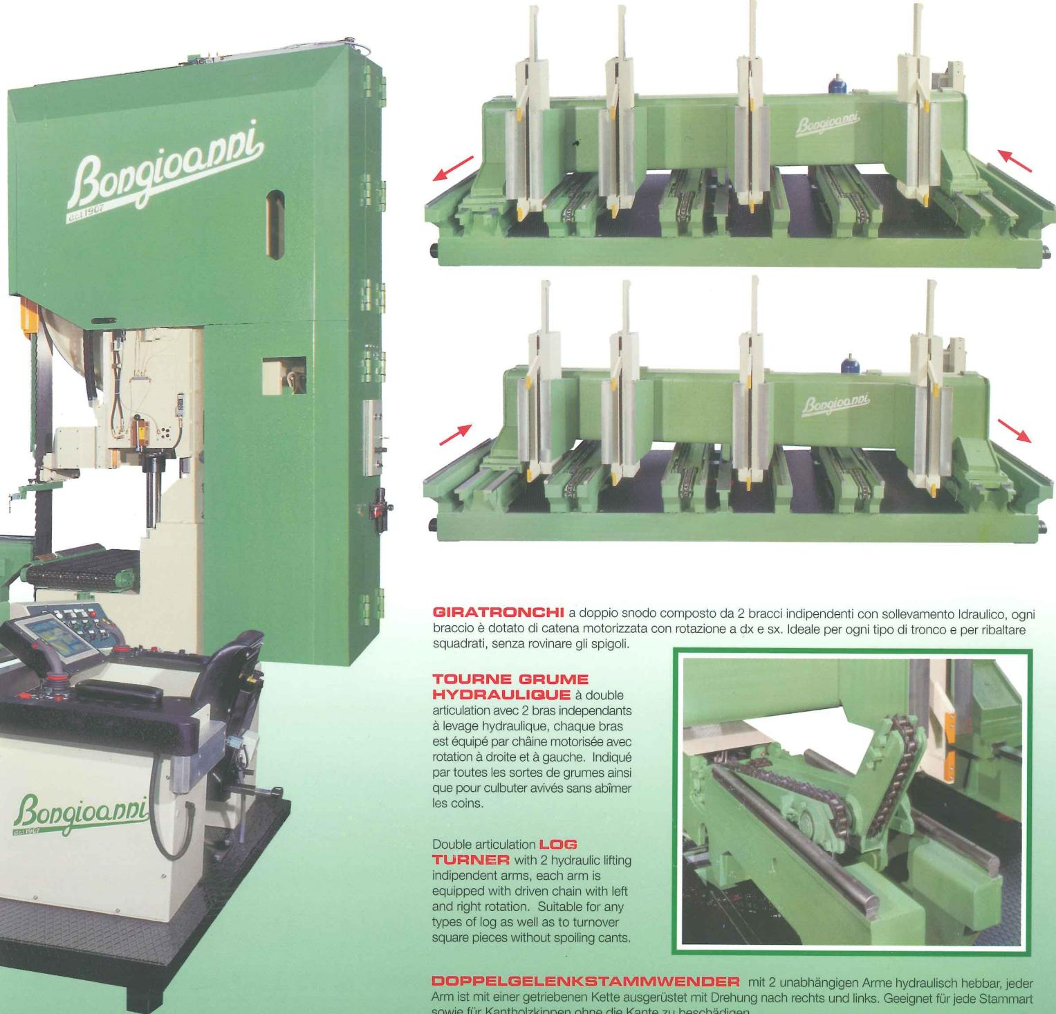
**GIRATRONCHI** a doppio snodo composto da 2 bracci indipendenti con sollevamento idraulico, ogni braccio è dotato di catena motorizzata con rotazione a dx e sx. Ideale per ogni tipo di tronco e per ribaltare quadrati, senza rovinare gli spigoli.
