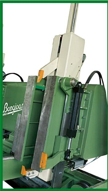
Bracci per rotazione a 90° dei semiprismi con sollevamento idraulico
